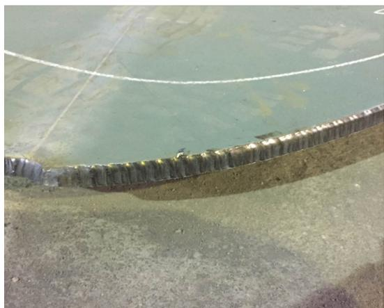
図 12 従来手法による切断 1
