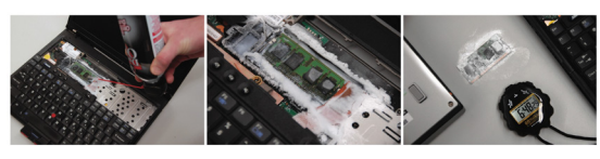
実際にDRAMを冷却して取り外す様子
